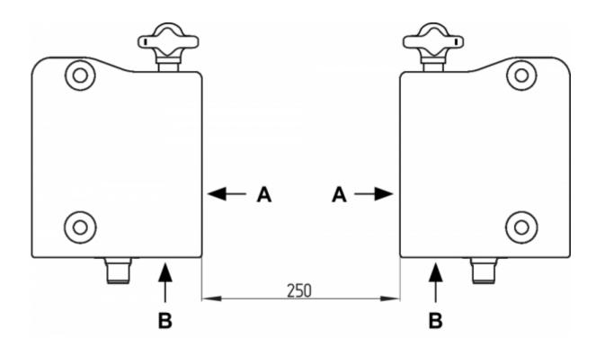
Mindsteafstanden for metalliske monteringsflader til forsiden "A" og til undersiden "B" på anordningen er 5 mm.
