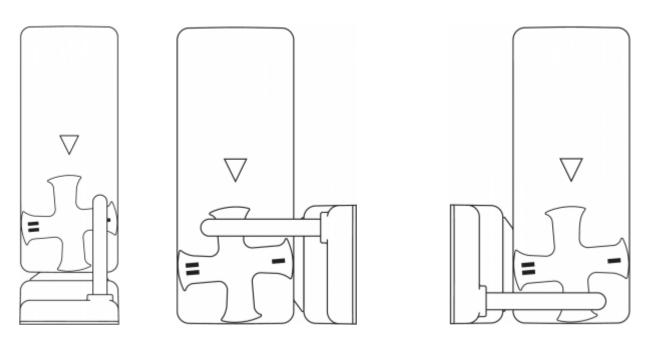
Illustrationerne viser en lukket beskyttelsesanordning ved en indstillet holdekraft på 50 N (se også kapitlet "Holdekraftindstilling").
