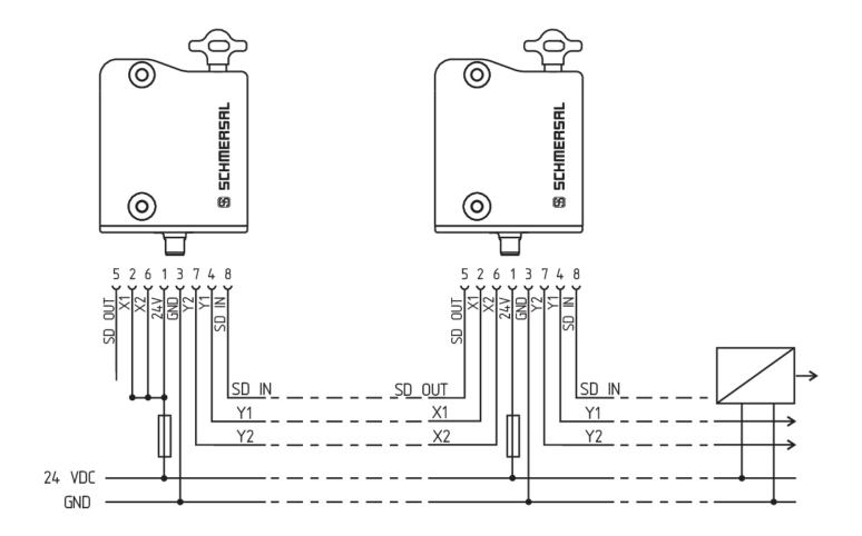
Y1 og Y2 = Sikkerhedsudgange  $\rightarrow$  Analyse SD-IN  $\rightarrow$  Gateway  $\rightarrow$  Fieldbus
