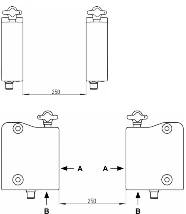
Mindsteafstanden for metalliske monteringsflader til forsiden "A" og til undersiden "B" på anordningen er 5 mm.
