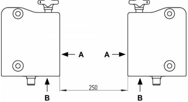
Mindsteafstanden for metalliske monteringsflader til forsiden "A" og til undersiden "B" på anordningen er 5 mm.
