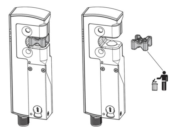
Der er to fastgørelseshuller til M5-skruer til fastgørelse af både sikkerhedsafbryderen og aktuatoren.
