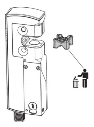
Der er to fastgørelseshuller til M5-skruer til fastgørelse af både sikkerhedsafbryderen og aktuatoren.
