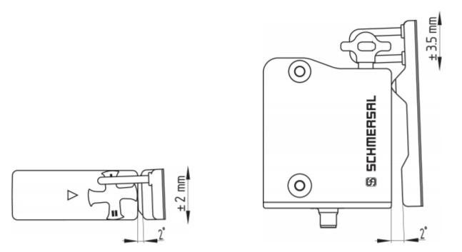
Sikkerhedsafbryderen med lås skal ikke bruges som anslag. Afhængigt af dørmassen og aktiveringshastigheden kan den mekaniske levetid forringes noget.
