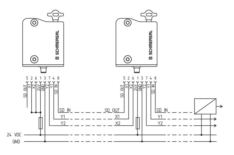
Y1 og Y2 = Sikkerhedsudgange  $\rightarrow$  Analyse SD-IN  $\rightarrow$  Gateway  $\rightarrow$  Fieldbus
