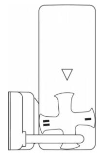
Illustrationerne viser en lukket beskyttelsesanordning ved en indstillet holdekraft på 50 N (se også kapitlet "Holdekraftindstilling").
