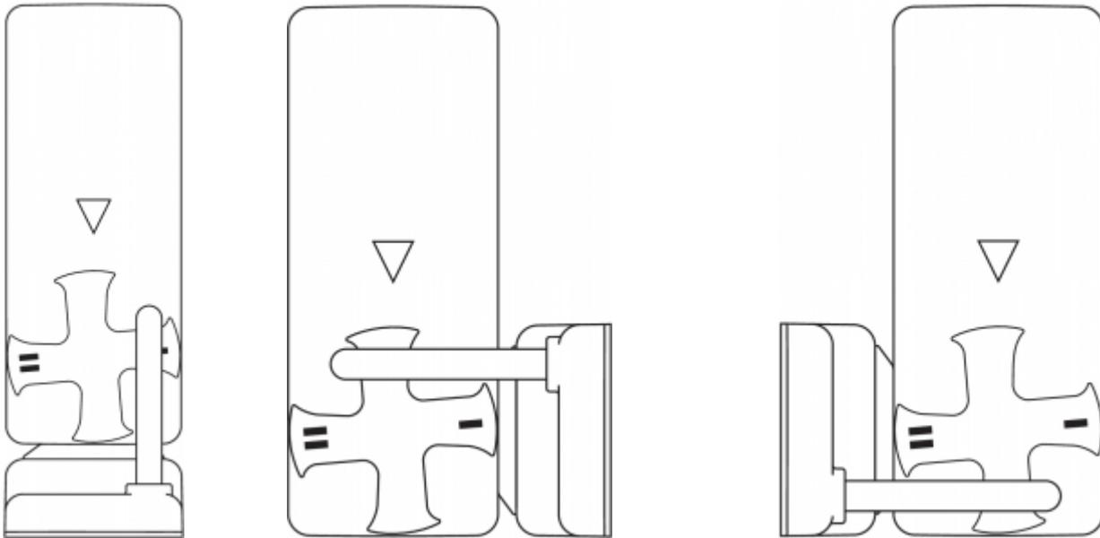
Abbildungen zeigen eine geschlossene Schutzeinrichtung bei einer eingestellten Rastkraft von 50 N (siehe auch Kapitel "Rastkraftverstellung").
