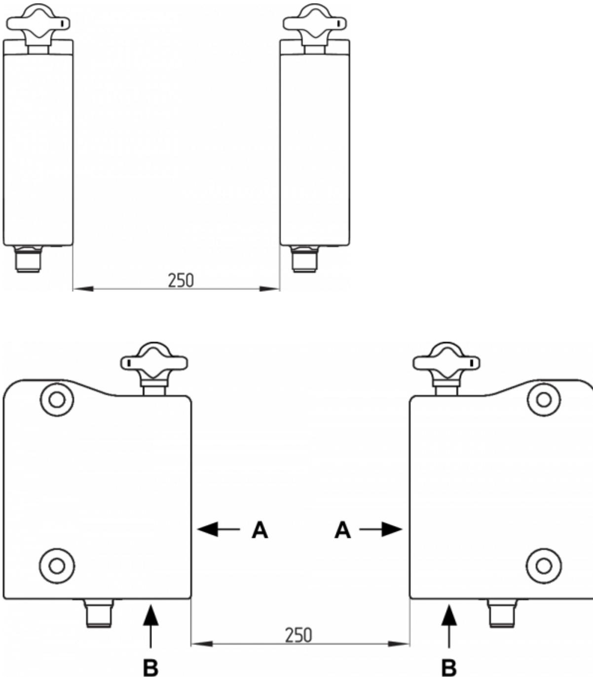
Der Mindestabstand von metallischen Befestigungsflächen zur Stirnseite "A" und zur Unterseite "B" des Gerätes beträgt 5 mm.
