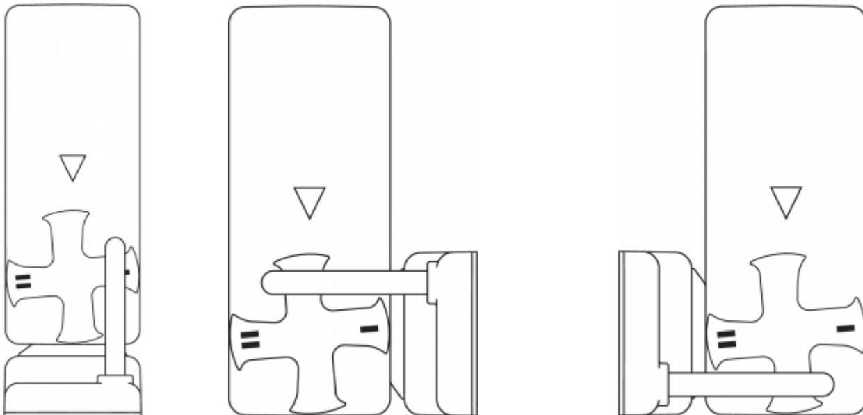
Abbildungen zeigen eine geschlossene Schutzeinrichtung bei einer eingestellten Rastkraft von 50 N (siehe auch Kapitel "Rastkraftverstellung").
