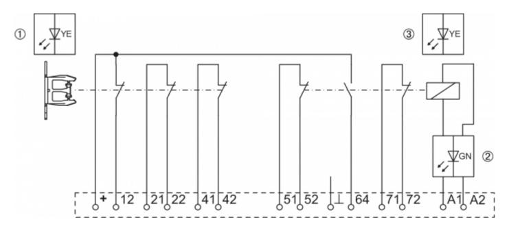
Die 24 V werden intern auf die Kontakte 11 und 63 geführt. Die zugehö-rigen Signale der LED-Anzeige können zusätzlich an den Klemmen 12 bzw. 64 abgegriffen werden.
