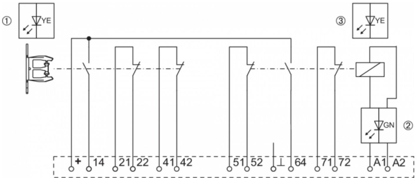
Die 24 V werden intern auf die Kontakte 13 und 63 geführt. Die zugehörigen Signale der LED-Anzeige können zusätzlich an den Klemmen 14 bzw. 64 abgegriffen werden.
