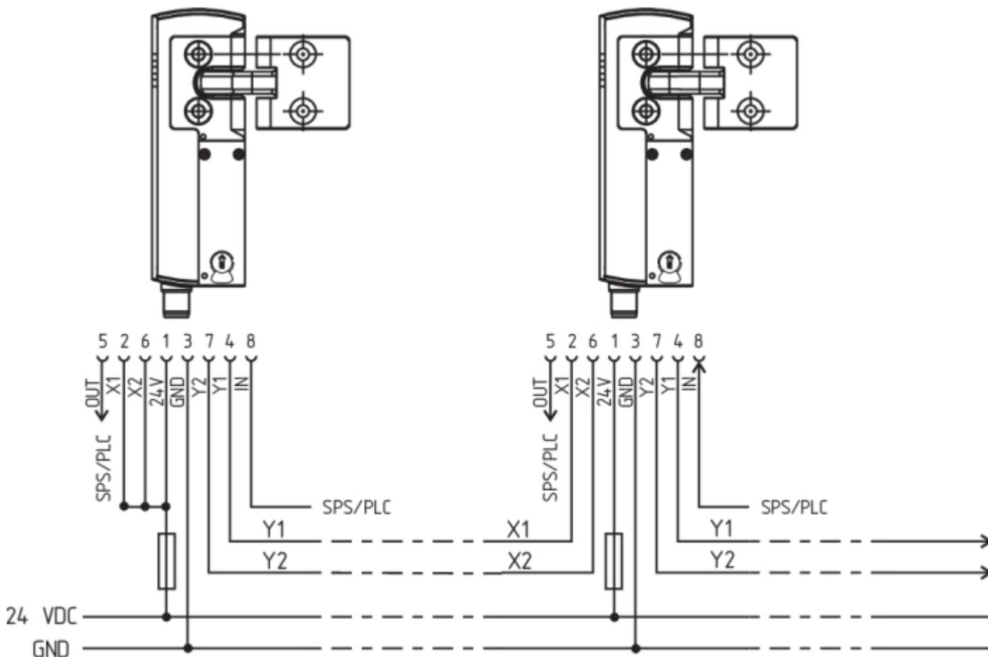
Y1 et Y2 = sorties de sécurité → module de sécurité
