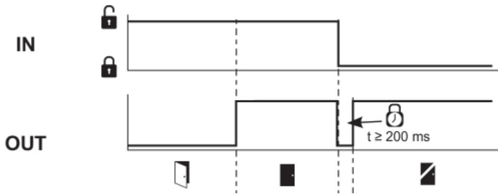
**Processus: signal de verrouillage est présent avant la fermeture du protecteur**
