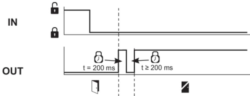
**Processus perturbé: le protecteur n' a pas pu être verrouillé ou un défaut est survenu**
