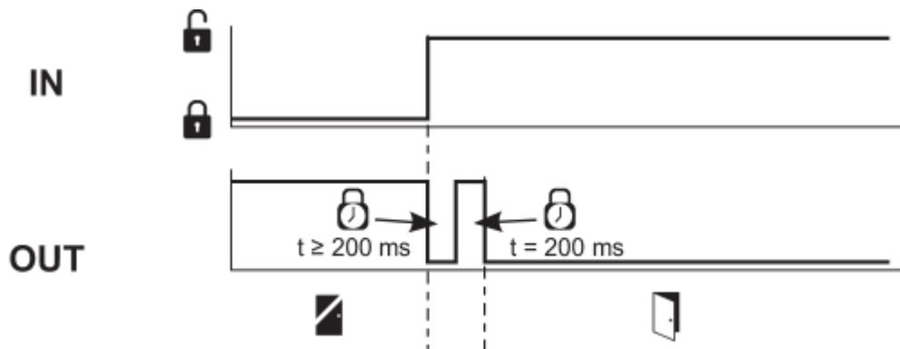
Processus perturbé, le protecteur n' a pas pu être déverrouillé
