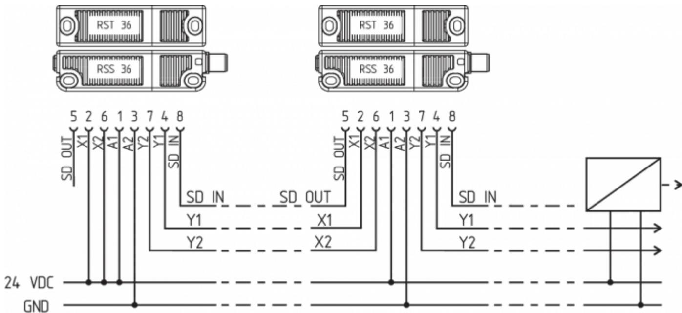
Y1 et Y2 = sorties de sécurité → module de sécurité
