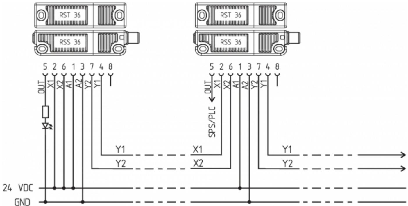
Y1 et Y2 = sorties de sécurité → module de sécurité
