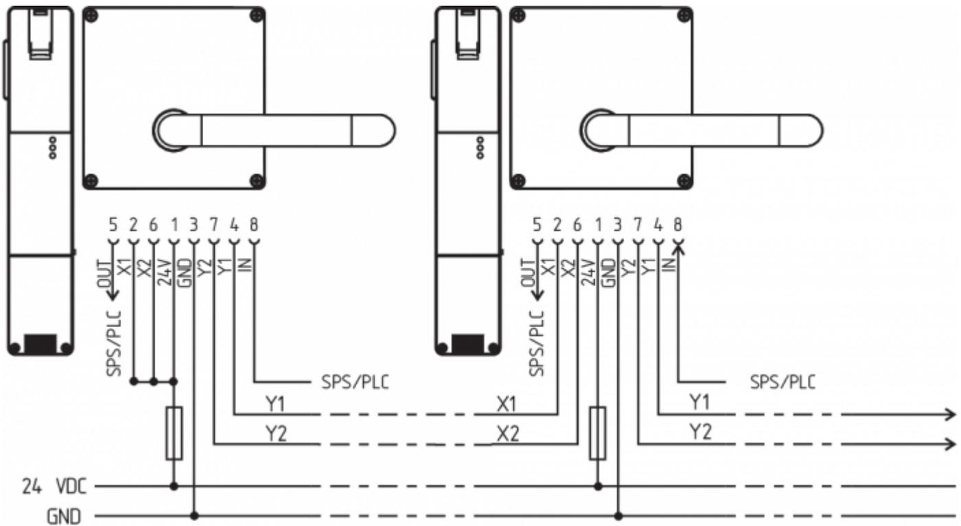
Y1 et Y2 = sorties de sécurité → module de sécurité
