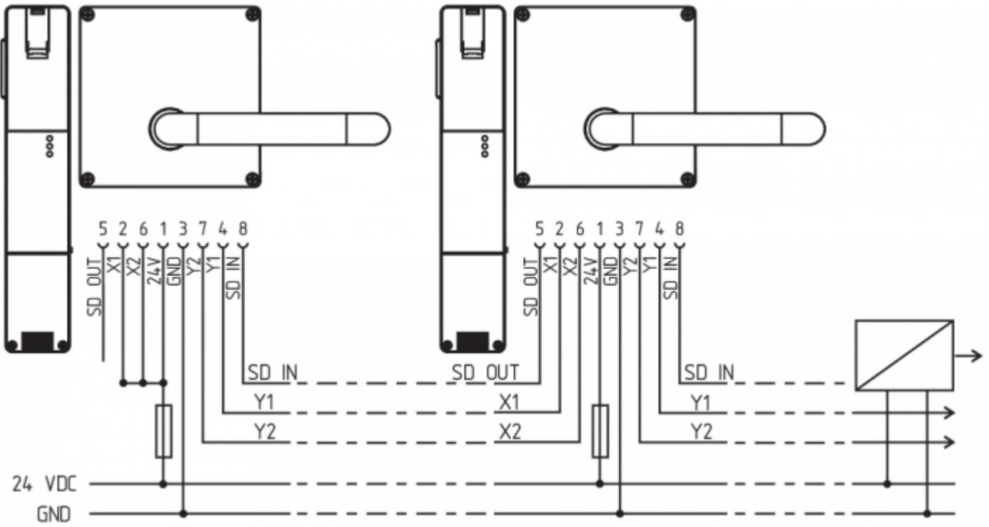
Y1 et Y2 = sorties de sécurité → module de sécurité
