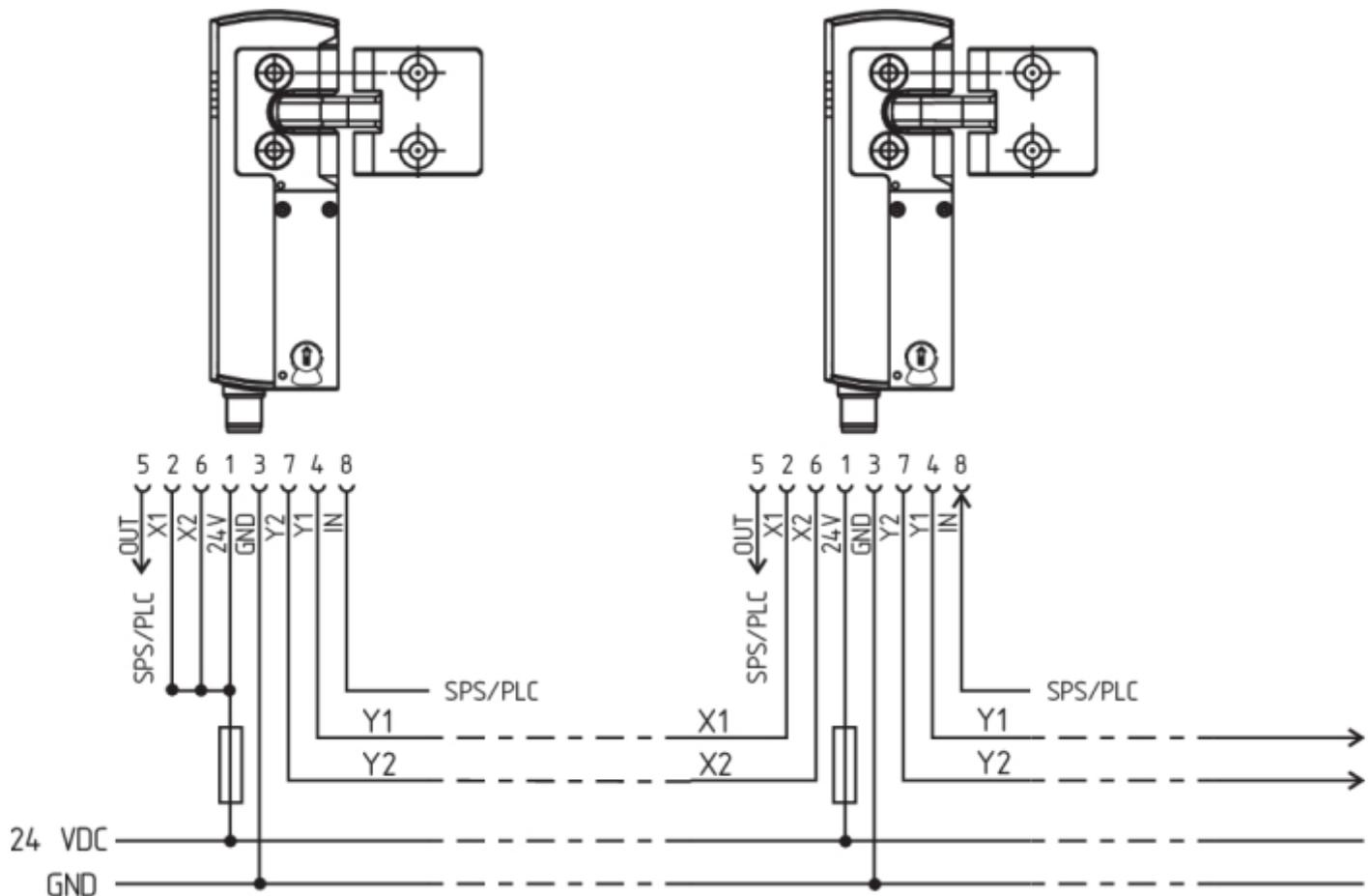
Y1 et Y2 = sorties de sécurité → module de sécurité
