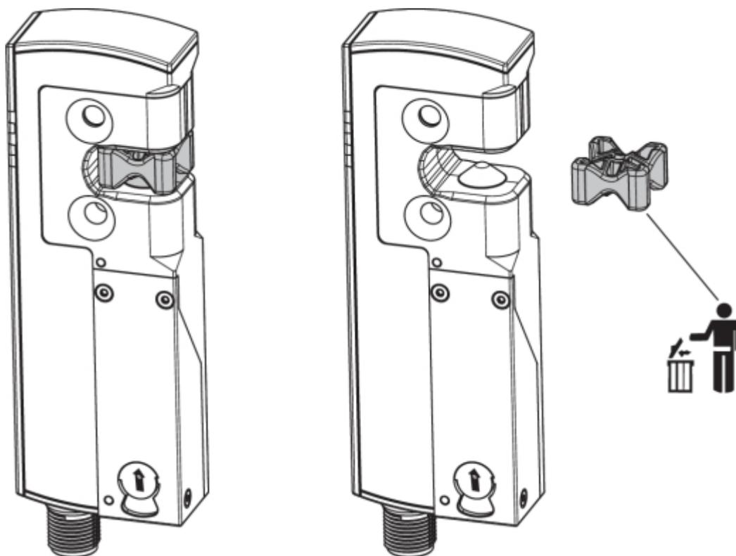
Deux trous de fixation pour vis M5 sont prévus pour monter l' interverrouillage de sécurité et l' actionneur.
