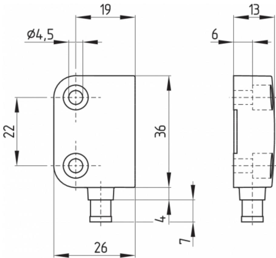
**Capteur de sécurité avec câble, charnière de porte à gauche**
