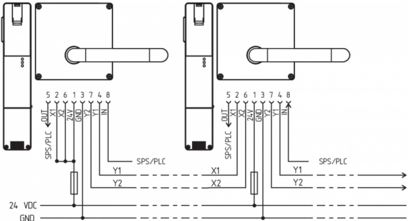
Y1 e Y2 = uscite di sicurezza -> modulo di controllo
