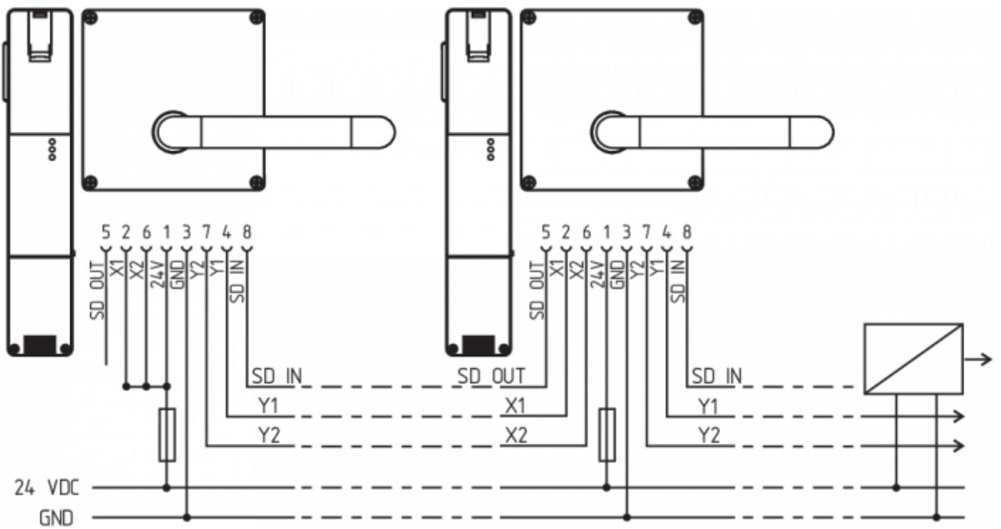
Y1 e Y2 = uscite di sicurezza -> modulo di controllo
