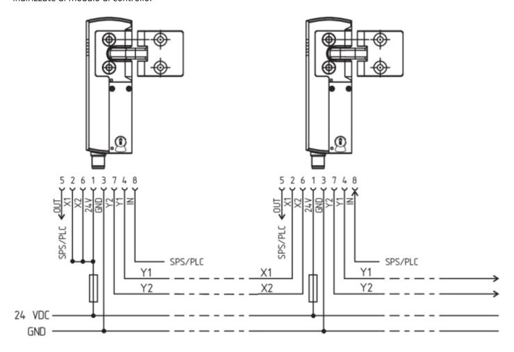
Y1 e Y2 = uscite di sicurezza -> modulo di controllo
