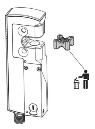
Per il montaggio dell'elettroserratura di sicurezza e dell'azionatore sono predisposti per ciascuno due fori di fissaggio per viti M5.
