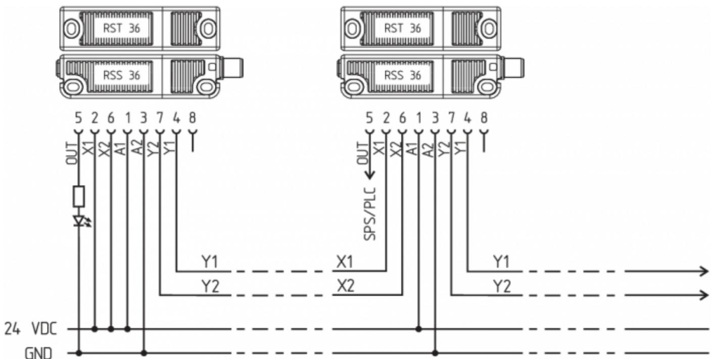
Y1 e Y2 = uscite di sicurezza -> modulo di controllo
