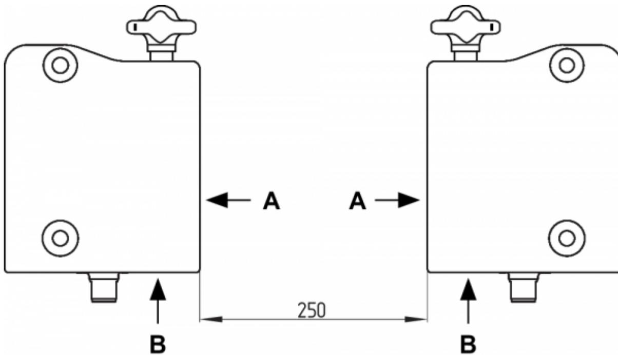
Der Mindestabstand von metallischen Befestigungsflächen zur Stirnseite "A" und zur Unterseite "B" des Gerätes beträgt 5 mm.
