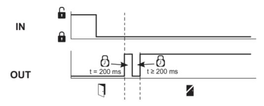
プロセスが中断され、ドアをロック出来ないか故障の場合
