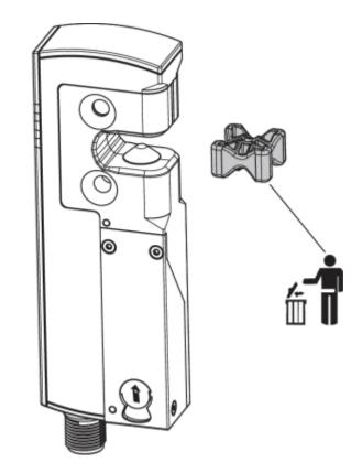
電磁ロック付きインターロックとアクチュエーターの取り付け用に、M5ネジ用の2つの取り付け穴があります。
