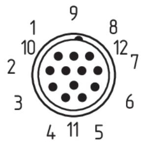
カッピング付き接続ケーブル（メス）IP67, M23, 12極 - 12 x 0.75 mm<sup>2</sup>
