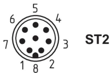
カッピング付き接続ケーブル（メス）IP67, M23, 8+1極 - 9 x 0.75 mm<sup>2</sup>
