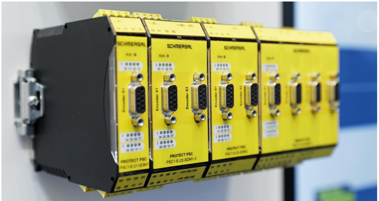
Die modularen Sicherheitssteuerungen der Produktfamilie PSC von Schmersal bieten die Möglichkeit, flexible Schutzsysteme softwarebasierend individuell zu konfigurieren
