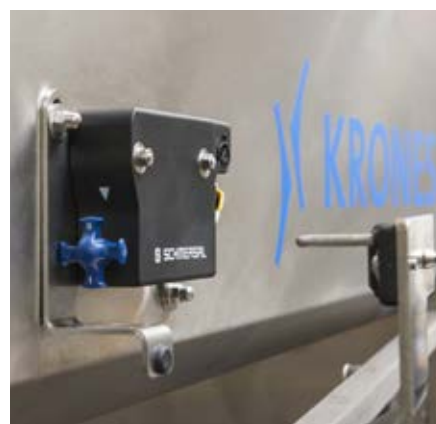
Fig. 1: O AZM300 com eficiência energética: Este interbloqueio de solenoide é versátil na sua utilização, graças a um novo tipo de sistema de interbloqueio que assume a forma de uma cruz Maltesa rotativa.
