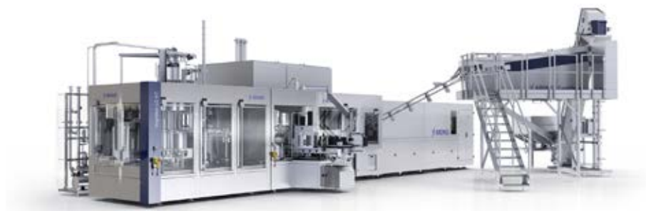
Fig. 3: Nos sistemas de enchimento Krones, o interbloqueio de solenoide AZM 300 e o sensor de segurança RSS 36 estão agora a ser usados: Ambos os componentes atingem o nível de codificação “alto”, de acordo com a norma EN ISO 14119.
