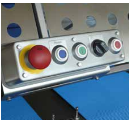
Fig. 2: A Schmersal também oferece caixas de montagem NBG prontas a conectar para as interfaces homem-máquina de máquinas de alimentos.
