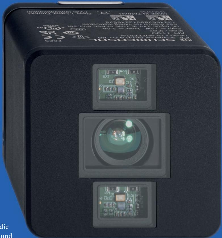
men ermöglichen eine Vorfilterung der Daten, sodass die Kamera an verschiedene Umgebungsbedingungen optimal angepasst werden kann. Die erfassten Bilddaten werden über die Standard-Datenschnittstelle GenICam übertragen und können so von gängigen Bildverarbeitungs-Softwareprogrammen ausgewertet werden. Eine Ethernet-Schnittstelle ermöglicht dabei schnelle und reichhaltige Datenübertragung und bei Bedarf auch die 24V-Energieversorgung (Power over Ethernet).
