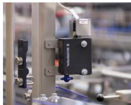
O interbloqueio de solenoide AZM300 possui um mecanismo inovador com mecanismo de bloqueio giratório em forma de cruz; a força de bloqueio pode simplesmente ser aumentada ao girar a cruz
