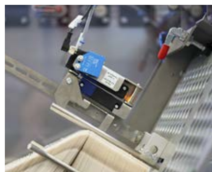
O sensor de segurança RSS 36 RFID encontra-se na unidade de alimentação da máquina
