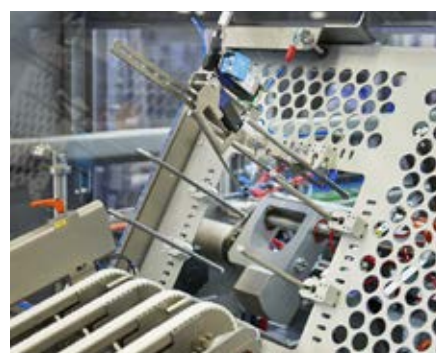
Se a entrada de material falhar, o RSS 36 aciona uma paragem da máquina
