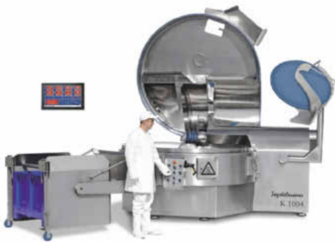
Ein Mitarbeiter bedient den Seydelmann-Kutter K1004. Für die unterschiedlichen Maschinenfunktionen gibt es mehrere Kreuzschalter.
