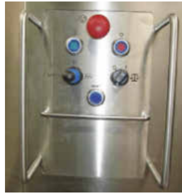
Der NK-Kreuzschalter, am Bedientableau unten links, lässt sich in bis zu vier Positionen bewegen: oben, unten, rechts, links
