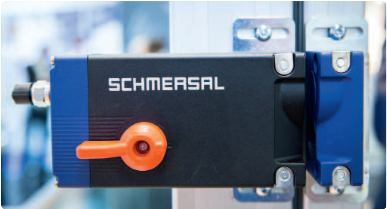
Die kompakte Sicherheitszuhaltung AZM400. Der rote Hebel ist die manuelle Fluchtentriegelung. Bilder: Schmersal
