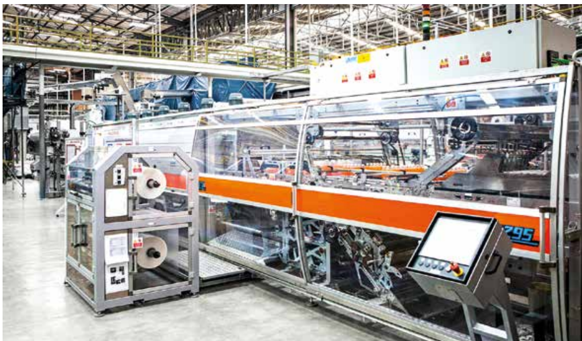
01 Die Folienverpackungsmaschine der Serie Fenix von Acmi wird mit je zwei großen Schiebetüren pro Seite abgesichert
