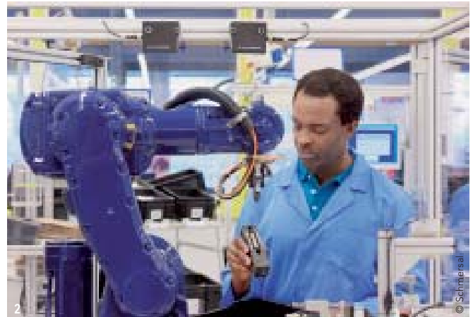
1 Die Schmersal-Safety-Installationssysteme: passive Verteilermodule PDM, passive Feldbox PFB und aktive Eingangserweiterungen SRB-E (von links). 2 Die direkte Zusammenarbeit von Mensch und Robotern ohne trennenden Schutzzaun wird in der Industrie 4.0 weiter zunehmen und mehr Sicherheitssteuerungen erfordern.
