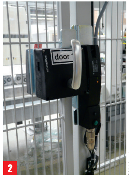
[2] Sicherheitszuhaltung AZM 200 in der für Jenoptik entwickelten Variante: sie erkennt auch die Position 'Schutztür angelehnt/geschlossen, aber nicht verriegelt'. Diese Funktion ist beim Einrichtbetrieb der Anlage wichtig.
