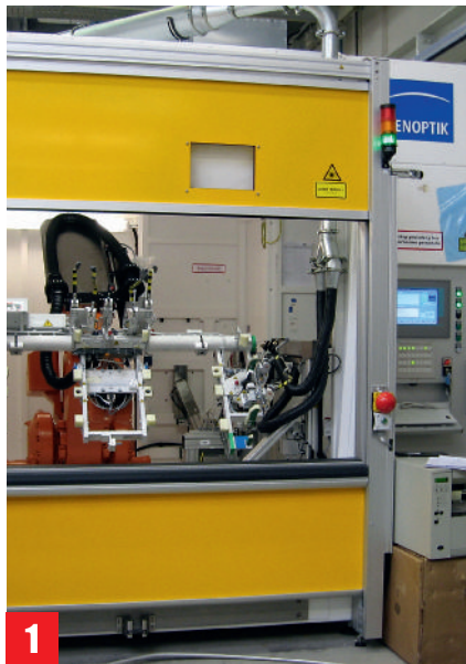
[1] Laserperforationsanlage für das präzise Perforieren von Bauteilen aus Kunststoffen, Textilien oder Leder im fast fertig montierten Zustand bei Jenoptik Automatisierungstechnik.
