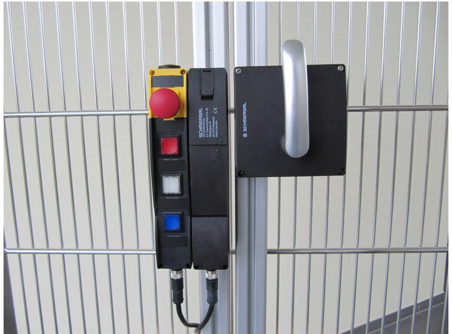
Bild 2: Sicherheitszuhaltungen können – gerade in der Automation – auch zum Prozessschutz eingesetzt werden. (Schmersal)
