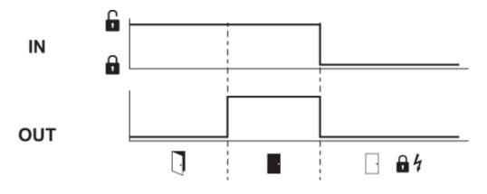
Normale afloop, deur werd ontgrendeld
