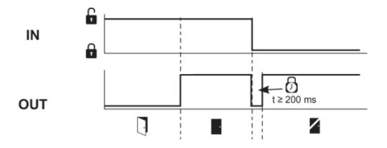
Afloop, vergrendelsignaal wordt geactiveerd voor het sluiten van de deur
