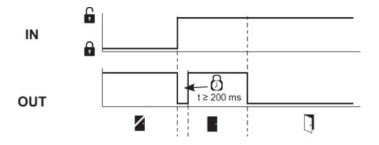
Afloop, deur opent onmiddellijk na het ontgrendelen
