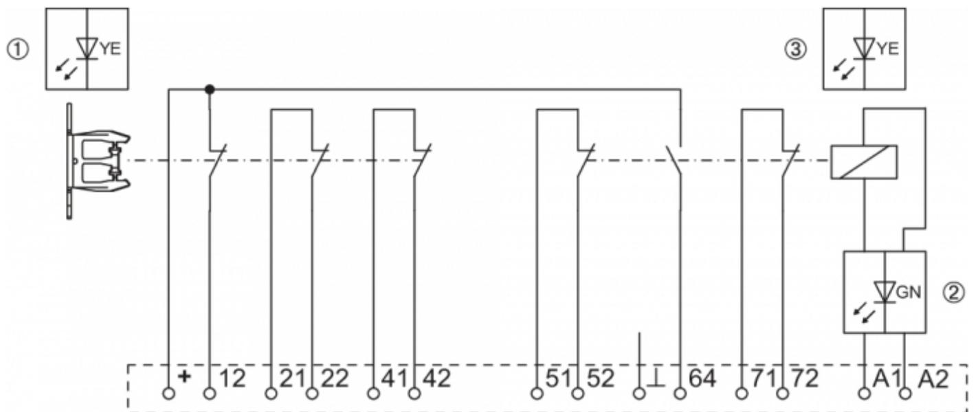
Die 24 V werden intern auf die Kontakte 11 und 63 geführt. Die zugehörigen Signale der LED-Anzeige können zusätzlich an den Klemmen 12 bzw. 64 abgegriffen werden.
