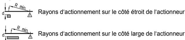
L'axe de rotation de la charnière et la face supérieure de l'interrupteur de sécurité doivent se trouver dans le même plan distant de d mm. A la livraison, l'actionneur est réglé pour des protecteurs avec le rayon le plus petit R<sub>min</sub>.
