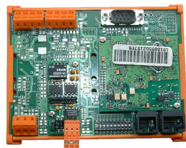
▲ Fig. 9 Carte à circuits imprimés CDG-01 servant de passerelle entre les réseaux CANopen ou servant aux diagnostics de données à distance.
