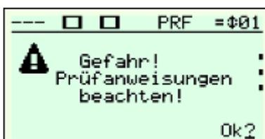
Der Warnhinweis im Display der Steuerung „Gefahr! Prüfanweisungen beachten!“ erscheint nach Aktivierung in den Prüfungsmodus.
