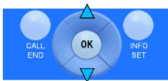
Der Start des Tests erfolgt durch Wahl einer Richtungstaste aufwärts oder abwärts.
