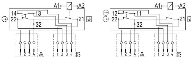
**Conexión con conector -ST, principio de bloqueo por tensión**
