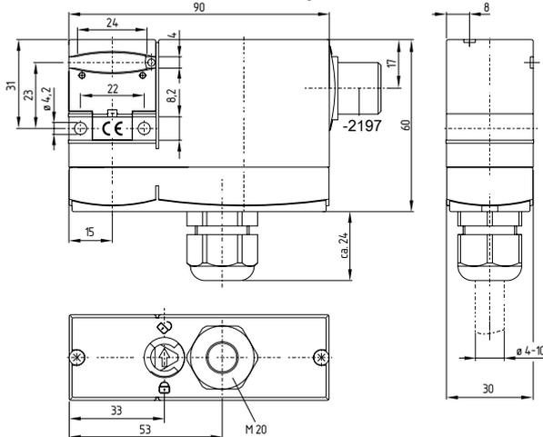
AZM 170 SK con terminales de tornillo y entrada de cable
