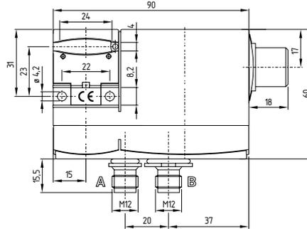
AZM 170...-ST8 con conector M12, con codificación A
