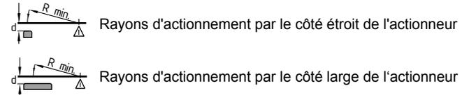
L'axe de rotation de la charnière et de la face supérieure de l'interrupteur de sécurité doivent se trouver dans le même plan distant de d [mm]. À la livraison, l'actionneur est pré-réglé pour des protecteurs avec le plus petit rayon R<sub>min</sub> [mm].
