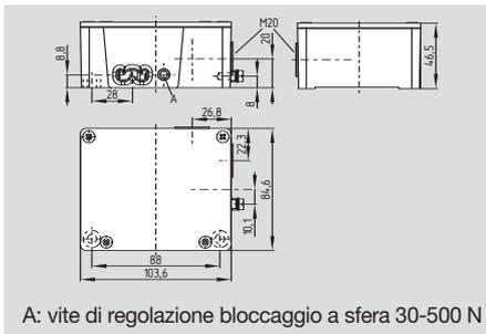
A: vite di regolazione bloccaggio a sfera 30-500 N
