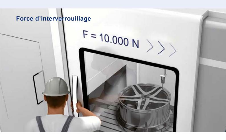
Force d'interverrouillage élevée et déverrouillage
