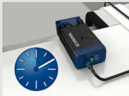
Blocco abilitazione di dieci minuti per l'acquisizione di un nuovo azionatore
