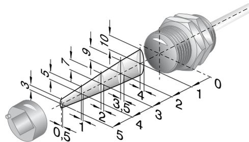
安定動作距離 :  $s_{ao} = 5 \text{ mm}$
