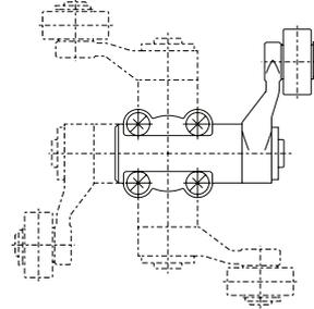
O elemento atuador pode ser deslocado 4 x 90°. Soltar os quatro parafusos da cabeça atuadora (perfil em cruz PZ2), mudar a cabeça atuadora para a posição desejada e reapertar os quatro parafusos (binário 1,5 Nm).
