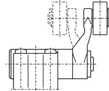
A alavanca com roldana pode ser ajustada em 180°, para que a roldana fique voltada para o interruptor ou na direção contrária.
