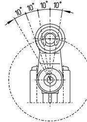
A alavanca basculante pode ser regulada com 10° passos em 360° sobre o eixo dentado. Girar o parafuso sextavado aprox. 4 mm para fora, mudar a alavanca para a posição desejada e reapertar o parafuso.
