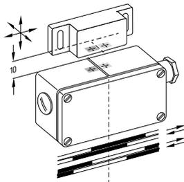
En las versiones -10 y -01, si el interruptor y el actuador magnético se encuentran uno delante de otro, debe observarse que la asignación de los colores sea correcta: rojo (S) con rojo (S) y verde (N) con verde (N).
