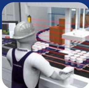
Los equipos cumplen con las exigencias de la norma EN ISO 13851 que, entre otros, determina la distancia entre los dispositivos de mando. El usuario puede elegir entre varias versiones, que se distinguen, entre otros, por el material de la caja (plástico o fundición inyectada de aluminio). En la parte central de las cajas se pueden montar hasta ocho dispositivos de mando y señalización adicionales.
