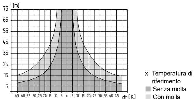
Figura 3: Lunghezza massima della fune in funzione della temperatura con o senza molla
