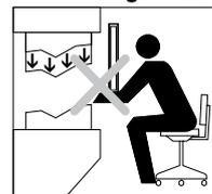
Gefährliche Maschinenteile können erreicht werden, ohne dass das Schutzfeld passiert werden muss.
