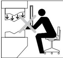
Le parti pericolose della macchina possono essere raggiunte senza passare attraverso il campo di protezione.
