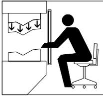
Le parti pericolose della macchina possono essere raggiunte solo passando attraverso il campo di protezione.
